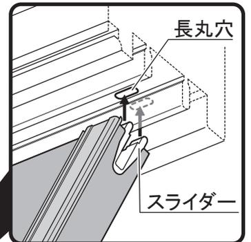
スライダーの先をアルミレールに空いている長丸穴に差し込み扉を取り付けてください。
