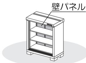
①壁パネルを側板後ろにはめ込み、縦方向(a)をボルトとパッキン付ネジ板で取り付け、横方向(b)をボルトとネジ板で取り付けます。
