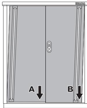
※3mm以上のスキマや上記の要領で調整できない時は、目隠しキャップをはずしベースの水平を出し直してください。(「2.ベース設置」を参照)
