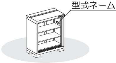
部品箱内の「型式ネーム」シールを側板右上部内側に貼り付けます。
